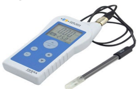
Fig. 5. Herramienta utilizada para medir la conductividad eléctrica
